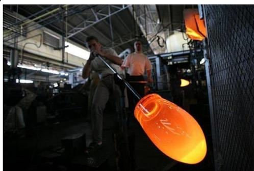
Само стекло выдувается при помощи длинной трубки. Так получают самые разные заготовки: шары, декоративная и лабораторная посуда, фигурки, и т. д. В своей работе ремесленники не ограничиваются одним инструментом. Для создания необычных форм применяются ножницы, сошки, щипцы, косарики и другие
